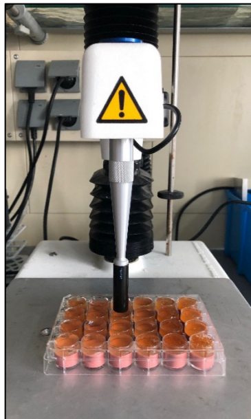
Abbildung 11: Texture Analyser mit Messstempel, der sich kurz vor dem Eindringen in die Probe befindet.
